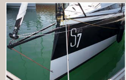
Pratique L'étrave est fine pour fendre le clapot méditerranéen. Le balcon fait office de chèvre grâce à un palan qui le fixe à l'étrave. Le bout-dehors est aussi basculant.
